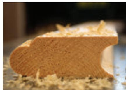
Изготовьте профилированные планки для постройки купели.
