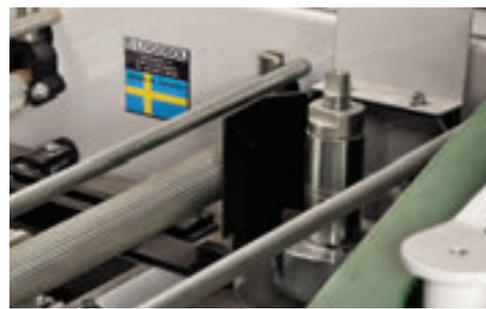
Валы шпинделя могут быть демонтированы, если вы хотите строгать заготовки шириной в 500 мм.
