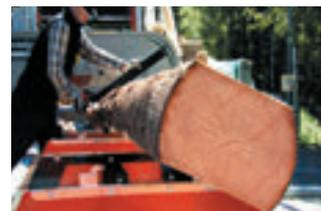
Поворачивание ствола облегчено удобным кантователем.
