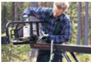
Бензопила просто устанавливается на салазки и с легкостью скользит по направляющим линейкам пилорамы.
