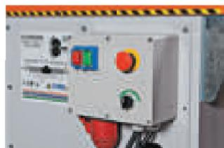
Вы управляете тремя двигателями станка при помощи панели управления.
