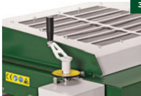
Пластина показывает размер до 0,1 мм.
