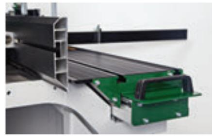
Стабильная и широкая каретка позволяет надежно закрепить заготовки различных размеров и форм.
