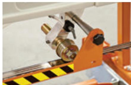
Точная, регулируемая настройка пильной ленты позволяет добиваться точных размеров доски.
