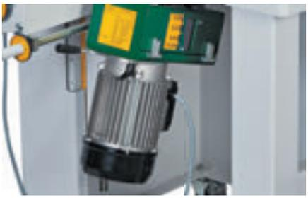
Узел двигателя со шпинделем может быть наклонен на 270 градусов. Эта функция дает вам возможность производить все: от массивных дверей до стилизованной под антик мебели.
