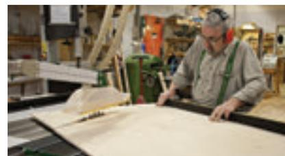
Направляющие станка могут быть направлены под разными углами. Пильный диск регулируется в вертикальном и горизонтальном направлениях.
