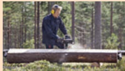
Подставки ведущей устанавливаются на одинаковую высоту. Таким образом вы получите максимальный выход доски из ствола и максимальную точность толщины каждой доски.
