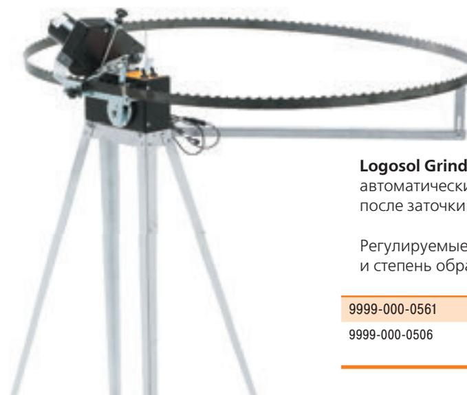
**Logosol Grindlux** точит пильные ленты автоматически. Станок останавливается после заточки каждой ленты.
