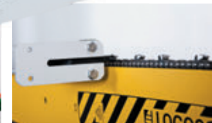
Стабилизатор верхушки шины увеличивает точность.
