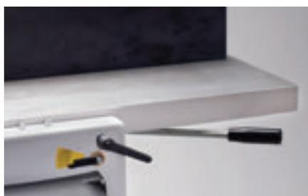
Передний стол фуганка регулируется рукояткой глубины обработки: от 0 до 10 мм.
